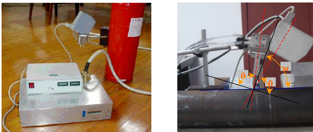
Figura 2. (a) Minidifratômetro para medição de tensões residuais em campo. (8) (b) Geometria descrita pelo conjunto tubo/detector.
