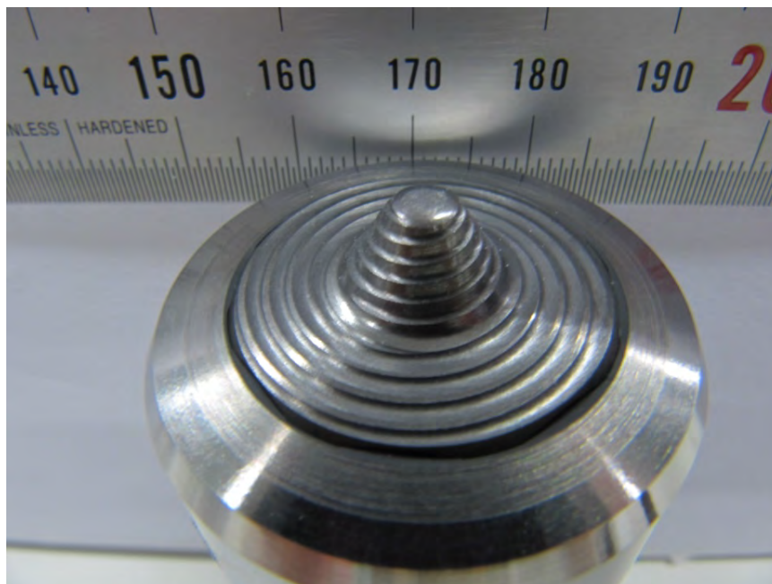
Figura 5. Ferramenta utilizada pra soldagens com 6,1 mm de penetração.
