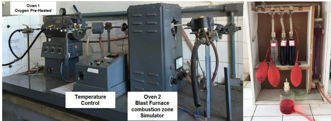
Figura 1- Simulador de injeção em altos-fornos e ORSAT para a análise dos gases.
