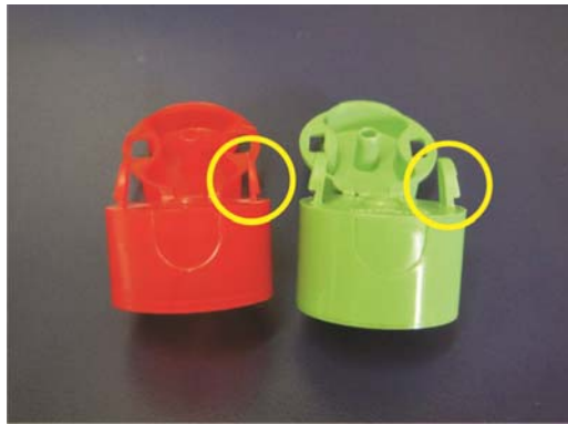
Figura 7. Comparação do gancho da aba nas peças vermelha e verde.
