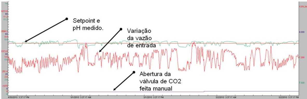
Figura 11. Resposta do controle antes da implementação do controle preditivo.
