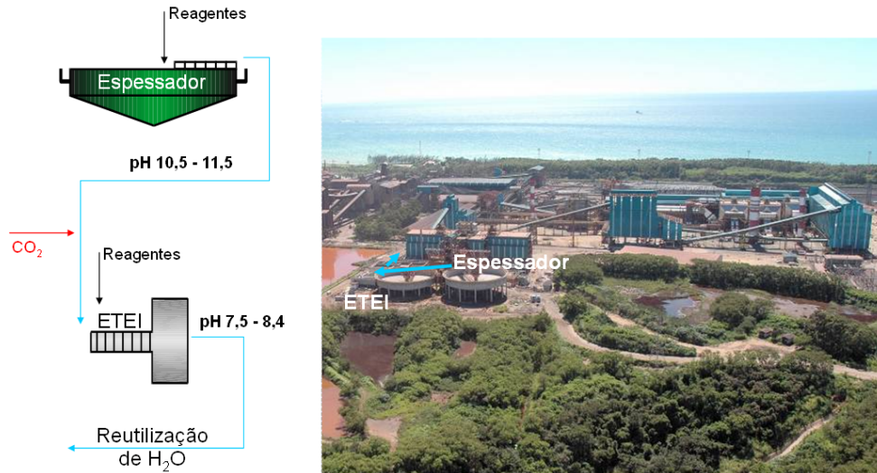
Figura 2. Fluxo do efluente industrial da usina 3 de Ubu.
