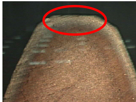
Figura 5: Topo do dente e a indicação do local da análise metalúrgico.
