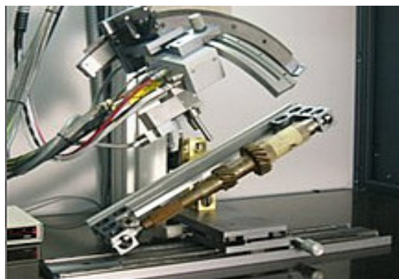
Figura 4. Posicionamento do componente completo, para ensaio por DRX.
