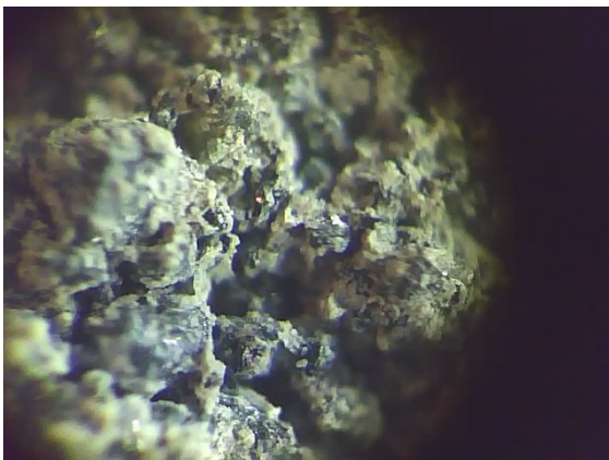
Figura 7. Morfologia dos aglomerados (pedaços) de areia e concreto visualizando a união entre as partículas e o acabamento superficial existente: (a) Areia “tipo A” após moldação e antes da fundição; (b) Areia “tipo A” após a fundição; (c) Areia “tipo B” após a fundição; (d) Concreto após a fundição. Estereomicroscópio, 4X.
