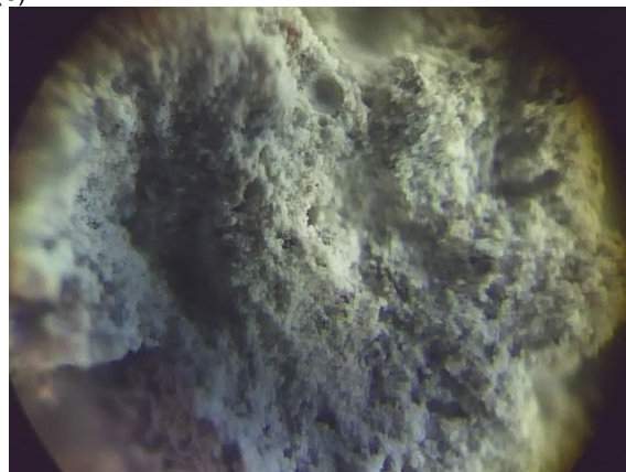
Figura 7. Morfologia dos aglomerados (pedaços) de areia e concreto visualizando a união entre as partículas e o acabamento superficial existente: (a) Areia “tipo A” após moldação e antes da fundição; (b) Areia “tipo A” após a fundição; (c) Areia “tipo B” após a fundição; (d) Concreto após a fundição. Estereomicroscópio, 4X.
