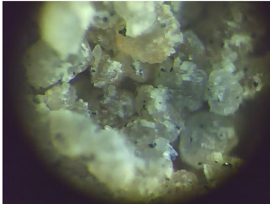
(c) (d) Figura 6. Morfologia dos aglomerados (pedaços) de areia e concreto visualizando a união entre as partículas: (a) Areia “tipo A” após moldação e antes da fundição; (b) Areia “tipo A” após a fundição; (c) Areia “tipo B” após a fundição; (d) Concreto após a fundição. Estereomicroscópio, 1X.
