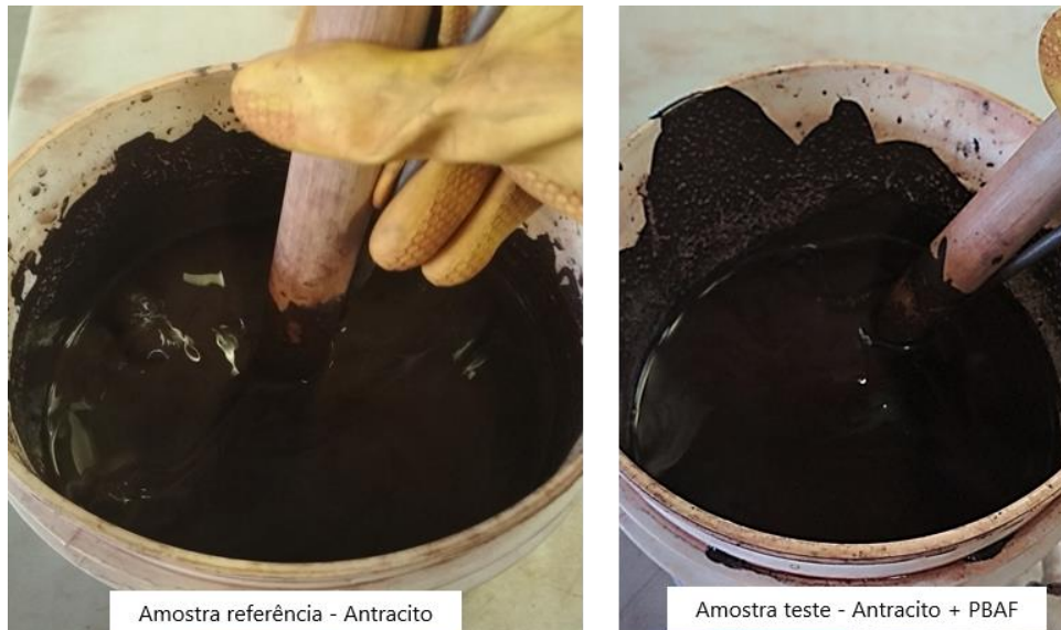
Figura 6. Experimento de simulação da homogeneização da polpa
