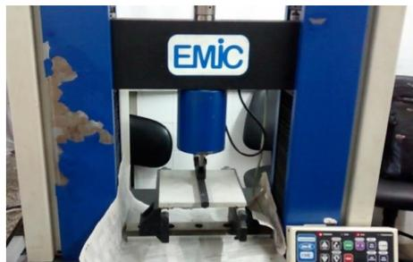
Figura 4. Ensaio de resistência à flexão
