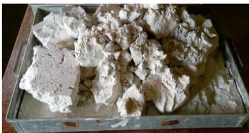
Figura 2. Resíduo de granito após secagem
