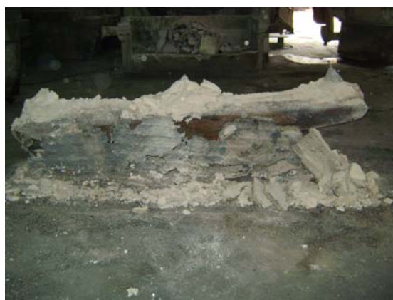
Figura 1. Cascão do fundo do distribuidor.
