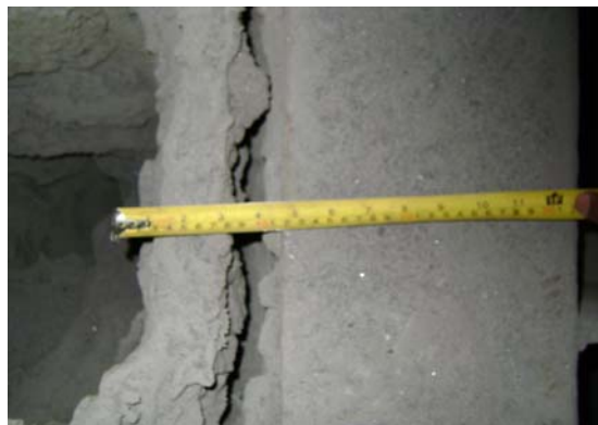
Figura 2. Medição da espessura do casão.
