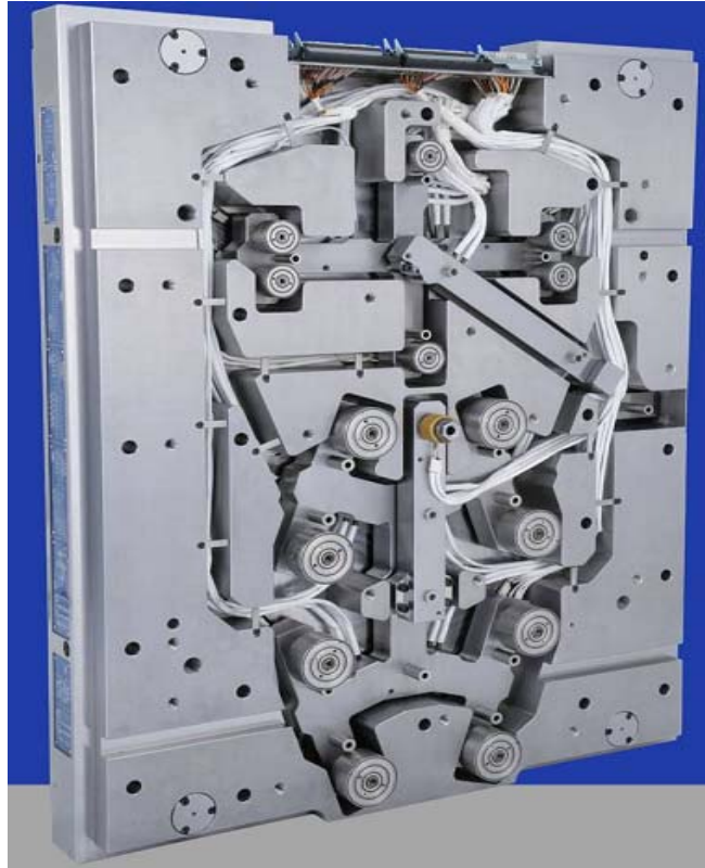
Figura 7. Sistema preparado para o processo de injeção seqüencial.
