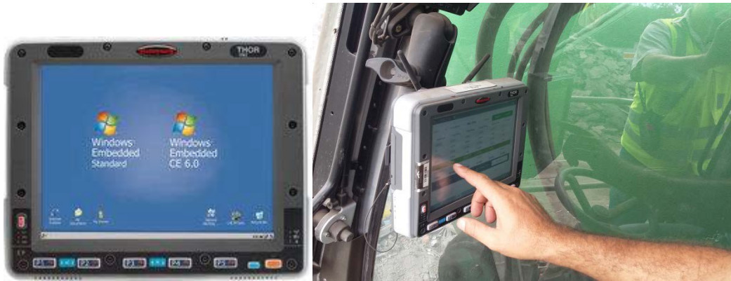
Figura 11. Computador industrial por onde o operador da manipuladora de sucata opera o novo sistema
