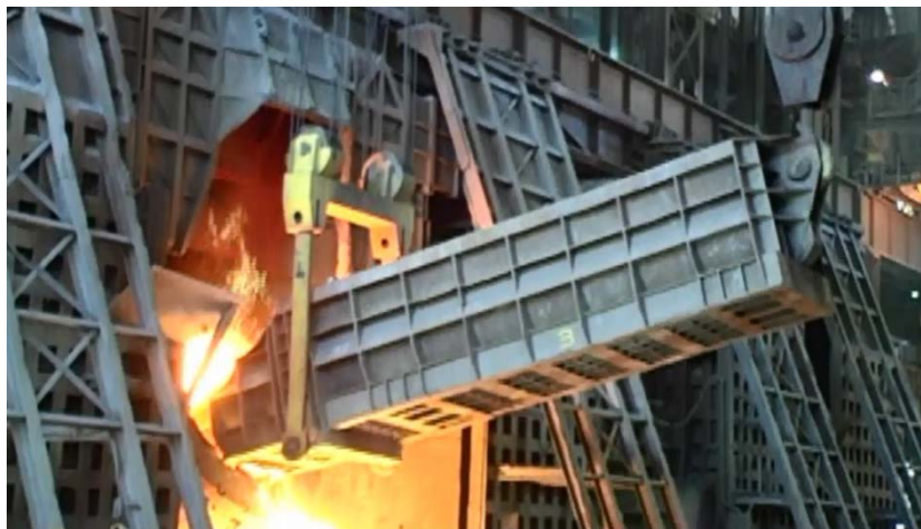
Figura 2- Adição de sucata no convertidor por meio de canaletas
