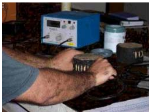
Figura 1. Ensaio de velocidade do pulso ultra-sônico
