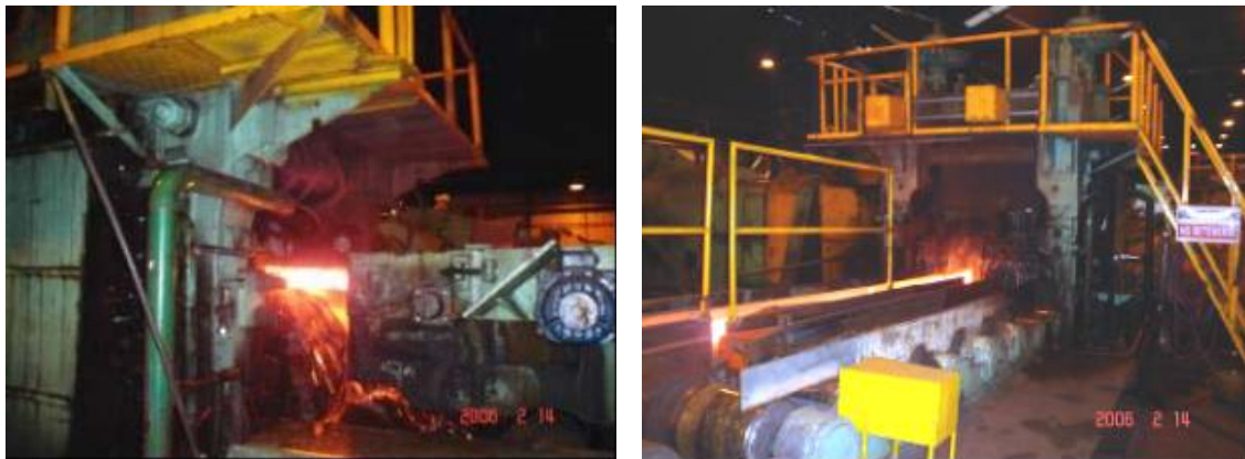
Figura 1. Desbastador trío reversible T 600 en operación.
