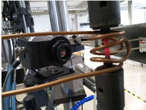
Figura 7. Ensaio de tração a quente sendo realizado no corpo de prova de aço AISI 1045.
