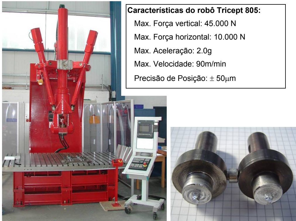
Figura 1 – FSW Robô Tricept 805 e ferramenta utilizada (pino facetado com rosca).
