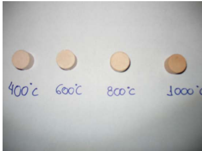
Figura 2: corpos de prova depois de levado a queima nas temperaturas referidas
