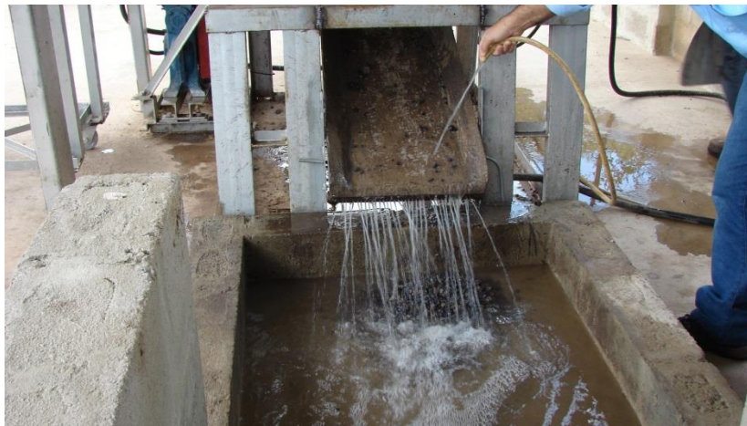
Figura 5. Vazamento e resfriamento brusco, arquivo próprio.
