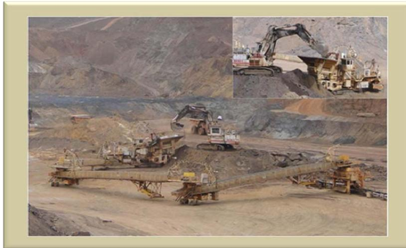
**Figura 1.** Britagem móvel auto propelida em operação.
