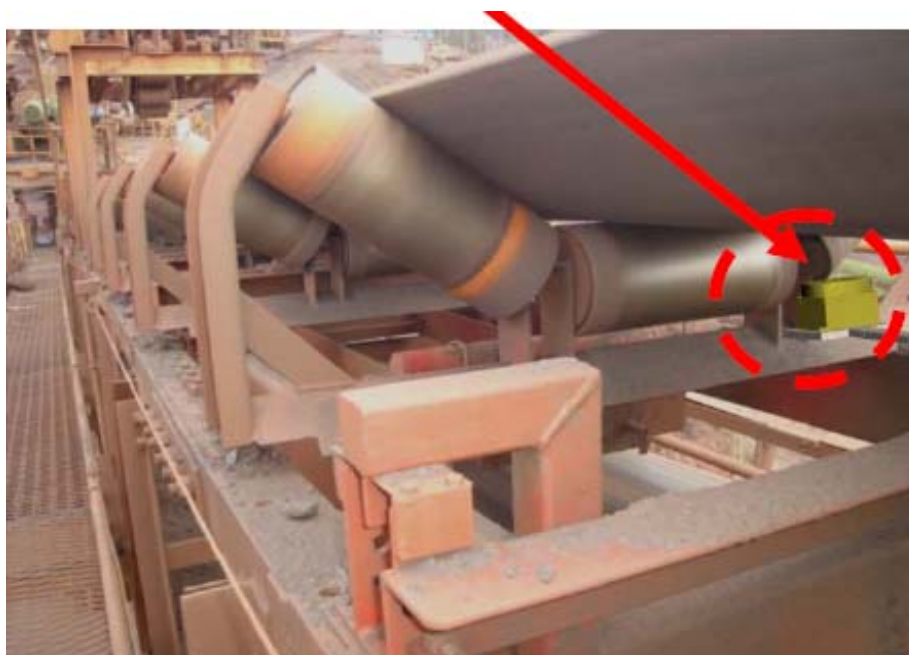
Figura 1. Medição de tensão da correia.
