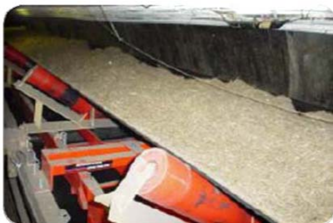
Figura 21. Balança pesando cavaco de madeira.
