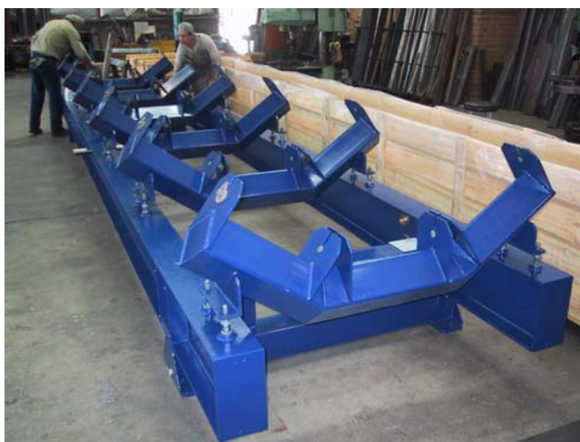
Figura 17. Ponte de pesagem flutuante com 6 roletes com distancia entre eles estendida para 2m .
