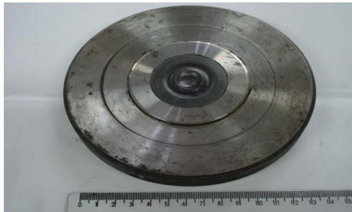
**Figura 4.** A bigorna toroidal com diâmetro da concavidade de 16,5mm é montada com cintamento.
