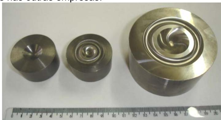
**Figura 3.** As bigornas com três tipos de perfil da concavidade fabricadas pela empresa DURIT.
