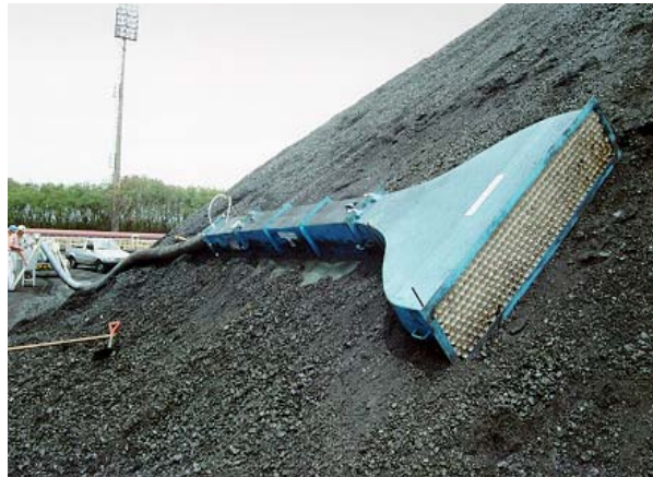
Figura 6. Vista de aplicação do Túnel de Vento Portátil em pilha de carvão da CST.
