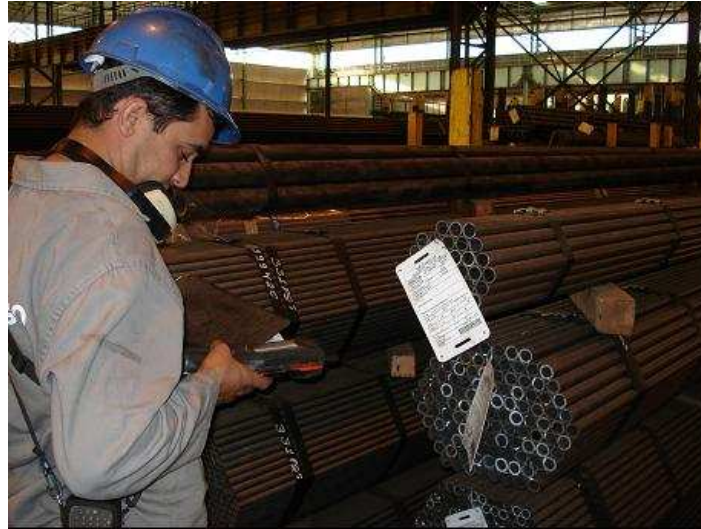
Figura 7 - Marcação dos lotes através do leitor de código de barras.
