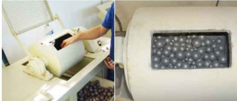
Figura 3. Exemplos de Moinhos utilizados no teste de Wi de Bond (Imagem cedida pela Metso, 2018)
