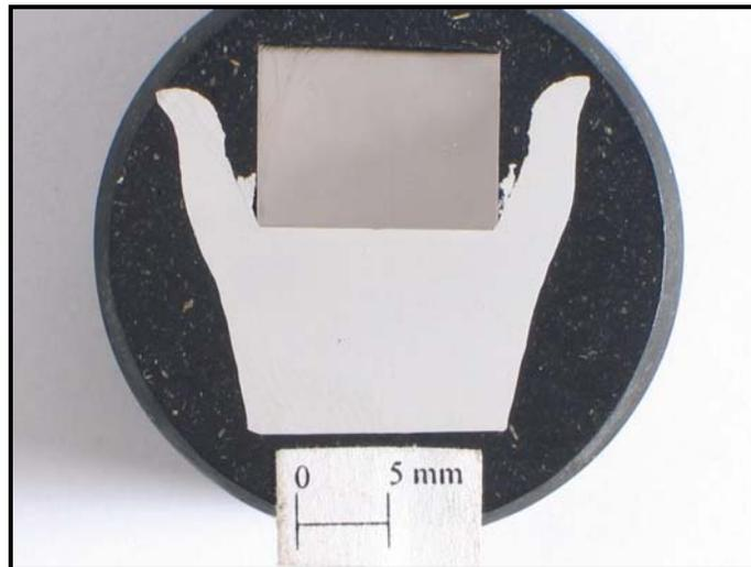
**Figura 2** - Observa-se o embutimento do aço inoxidável no alumínio.
