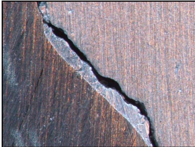
**Figura 7** - Fotoestereografia com aumento de 16 X. Observa-se que a fratura ocorreu na estrutura do alumínio.
