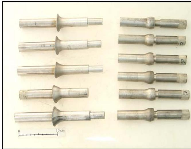
**Figura 1** - Vista geral de corpos-de-prova obtidos pelo processo de soldagem por fricção.
