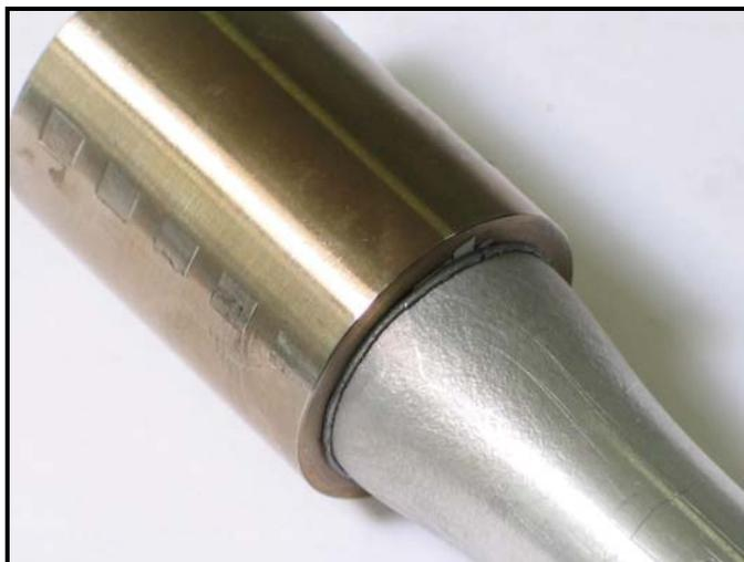
**Figura 5** - Observa-se a deformação do alumínio preenchendo toda a folga entre o aço inoxidável e o alumínio.
