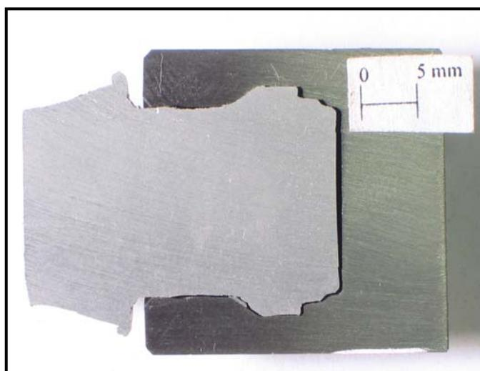
**Figura 6** – Corpo-de-prova seccionado longitudinalmente, após ensaio mecânico.
