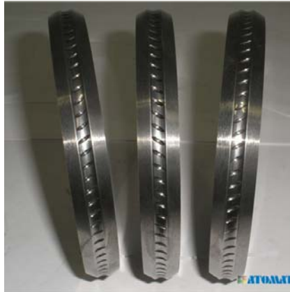
Figura 6 - Exemplo de rolos do cassete laminador.
