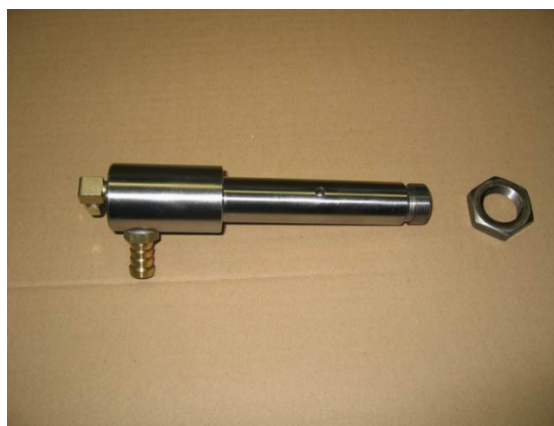
Figura 9 - Pino de refrigeração.
