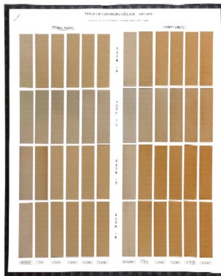
Figura 5 - Amostras processadas para levantamento da cinética de oxidação cíclica.
