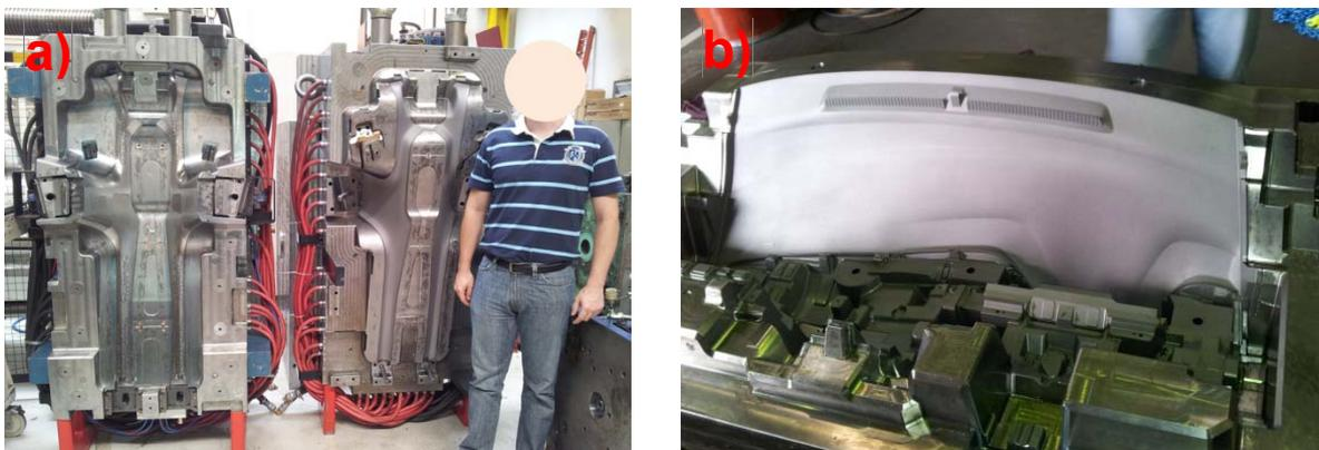
**Figura 13.** Moldes para injeção de peças automotivas. a) Molde do revestimento inferior da Coluna B. b) Cavidade do molde para injeção de painéis de instrumentos de veículos.
