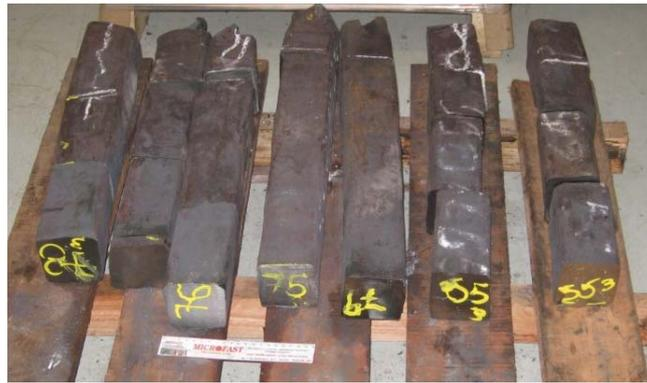
Figura 3. Barras forjadas a partir dos lingotes em escala piloto.
