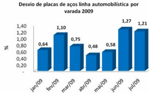
**Figura 2** – Placas desviadas por obstrução de canal em 1º semestre 2009.
