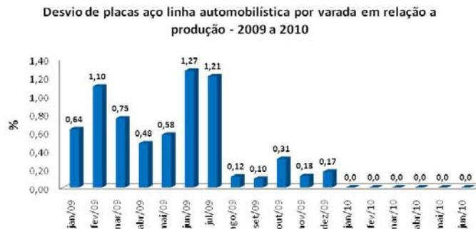
Figura 22 – Redução de varadas nos aços da linha automobilística.
