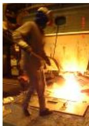
Figura 6 – Desobstrução do canal de vazamento do distribuidor (remoção de alumina - Varada).
