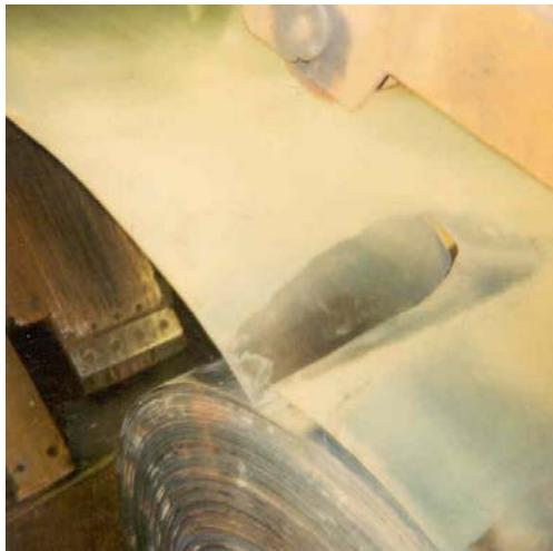
Fig. 1- Trinca causada por resfriamento excessivo da tira
