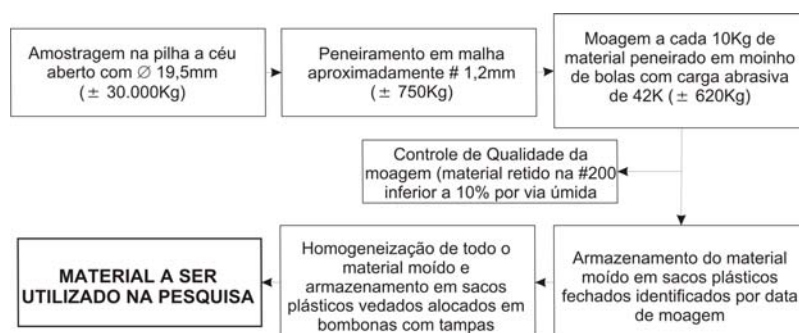
Figura 1. Fluxograma resumo do beneficiamento da escória de aciaria LD
