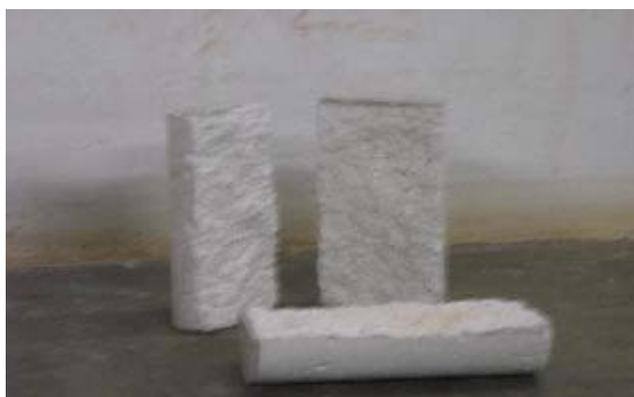
**Figura 3** - LSV argamassa com agregado de louça sanitária vidrada.Dimensões:1024 X 768 pixels TYPE: imagem JPEG.Size: 186KB
