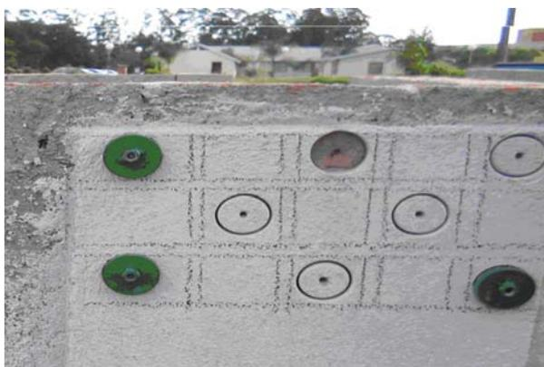
**Figura 6** Argamassa com agregado de LSV em substrato de tijolo cerâmico.<sup>(5)</sup>
