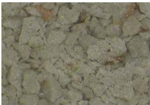
**Figura 1 - LSV** - Agregado miúdo louça sanitária vidrada. Mag 160 X.jpg (em relação a tela do computador);Dimensão: 640 X 480 pixels<sup>(5)</sup>
