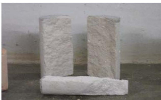
**Figura 4** - P1 argamassa com agregado natural areia de rio.Dimensões:1024 X 768 pixels. TYPE: imagem JPEG.Size: 192KB
