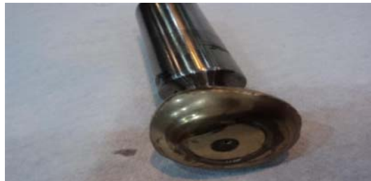
Figura 3. Pistão da bomba de Direção danificado.
