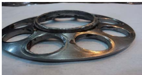
Figura 1. Placa de fixação dos pistões da Bomba danificada.
