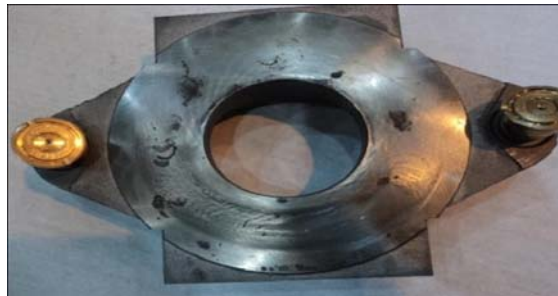
Figura 2. Placa de angulação da Bomba danificada.
