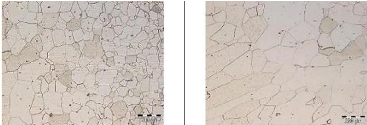
Figura 2. AISI 409 soldagem manual: a) região fora da solda 100 x; b) região solda 100 x (FONTE: AUTOR, 2017)
