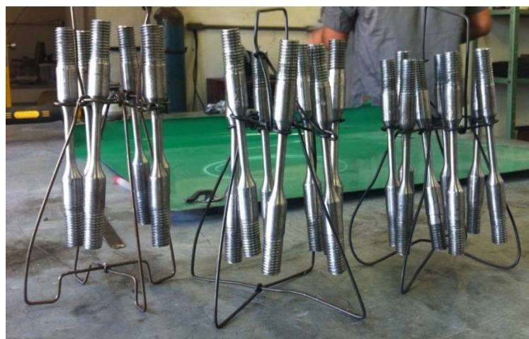
Figura 3: CP's dispostos no suporte, preparados para sofrer o tratamento térmico.
