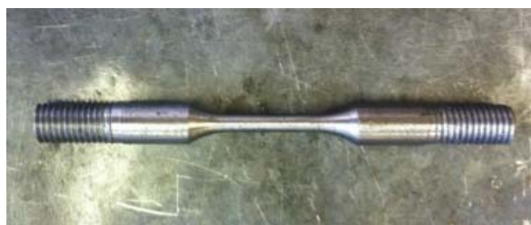
Figura 1: Corpo de prova usinado com rosca, anti-escorregamento.
