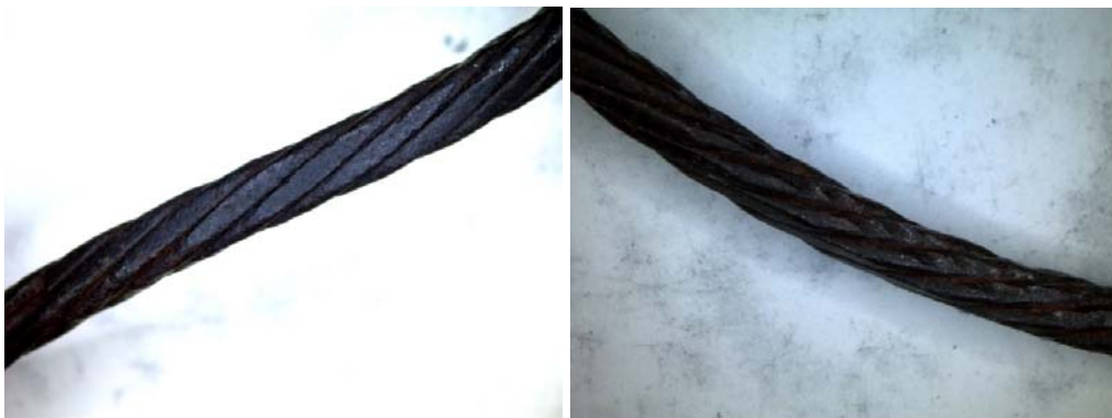
Figura 2. A imagem à esquerda mostra plano de desgaste em um segmento do cabo. A direita, a seta preta mostra o plano de desgaste da periferia do cabo e a seta clara mostra concavidades na parede de fios que indicam desgaste interno nos fios do cabo.
