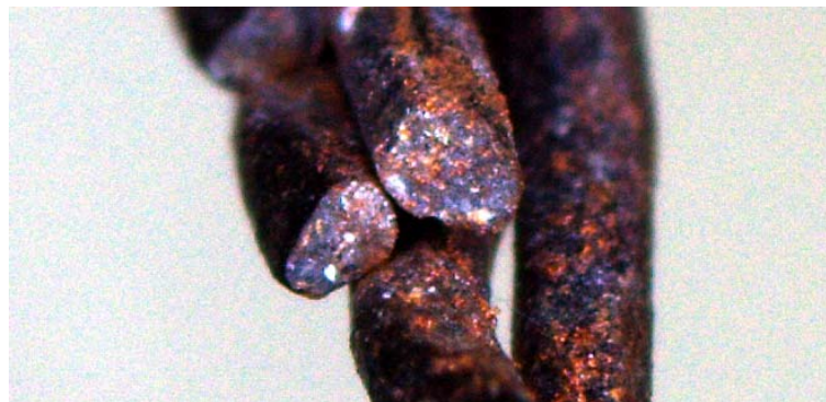
Figura 4. Fios que perderam a forma de seção circular no contato com outros fios, o que indica degradação interna por desgaste de atrito entre fios.
