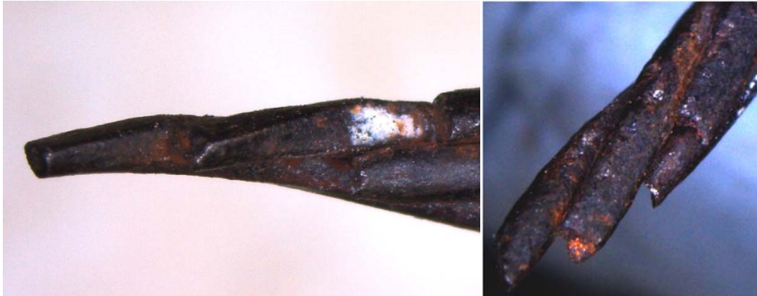
Figura 3. À esquerda, fios com fratura plana e com aspecto de desgaste (forma de meia lua); fio com fratura plana e fio com fratura do tipo taça cone. À direita, desgaste periférico e corrosão superficial dos fios.
