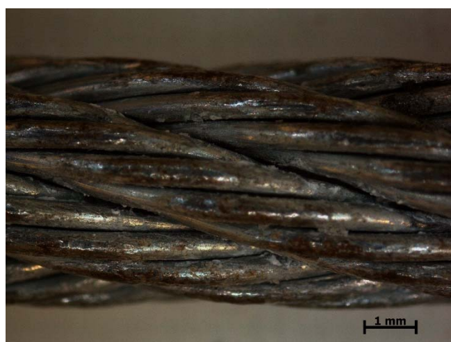
Figura 4: Cabo fornecido para comparação (Cabo 2) com desgaste em toda a sua extensão.
