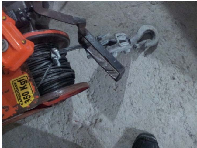
Figura 5 – Dispositivo modificado que mantém contato direto com o cabo.
