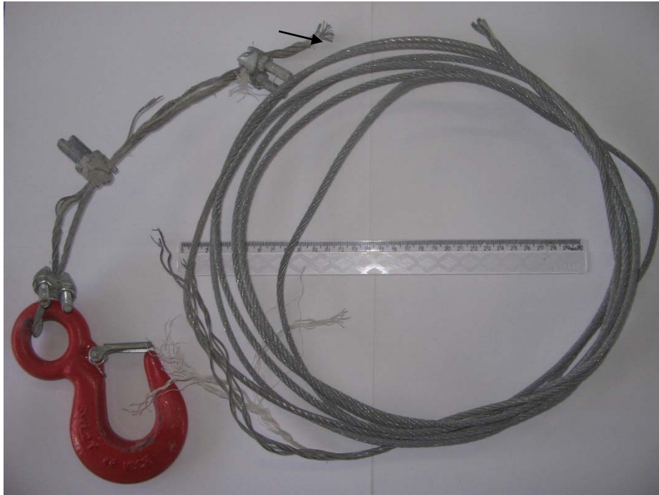
Figura 1: Foto do segmento do cabo de aço rompido em serviço. A seta indica a fratura.
