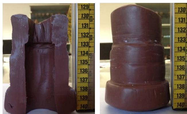
Figura 17. Geometria final do ensaio com plasticina utilizando o mandril de 0°.
