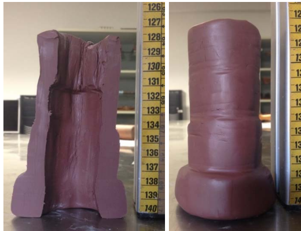
Figura 19. Geometria final do ensaio com plasticina utilizando o mandril de 60°.
