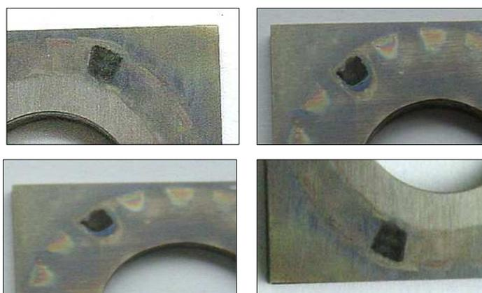
**Figura 2** – Aspecto visual das amostras de aço 12 % Cr após ensaios de corrosão localizada.
