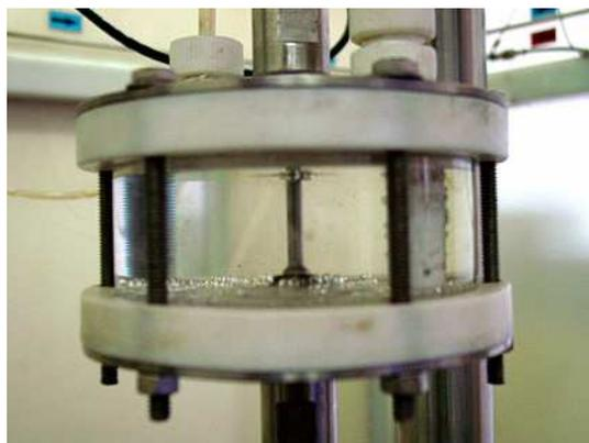
**Figura 1** – Imagem representativa do ensaio com baixa taxa de deformação.
