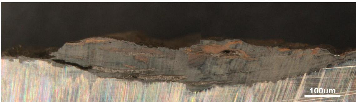
**Figura 1.** Tubo #1 - variação da espessura da camada de resíduos
