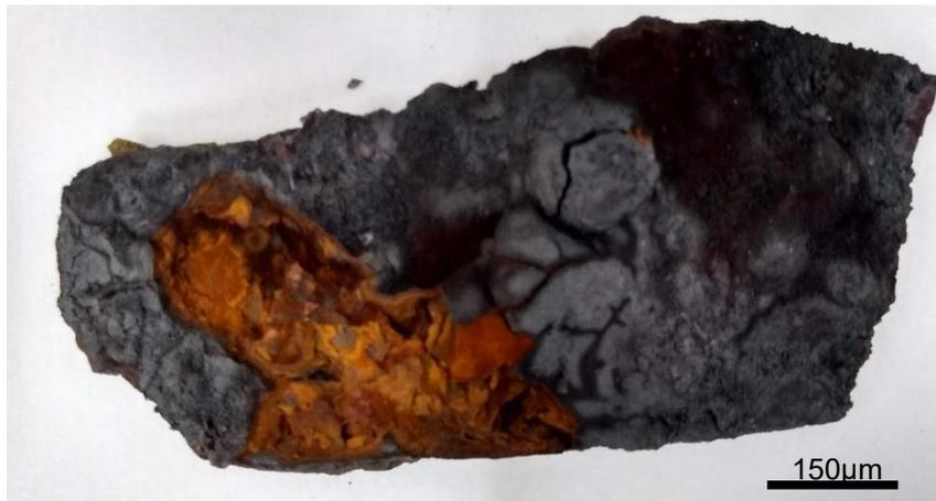
**Figura 5.** Fragmento da camada de resíduos mostrando a existência de compostos diversos sobre a superfície
