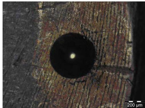
Figura 12: Micrografia de indentação Rockwell C, mostrando a região com trincas no revestimento na ferramenta usada. Ampliação 200x.
