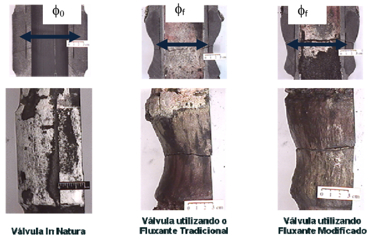
Figura 2. Exemplo de medição de desgaste de SEN. (9)
