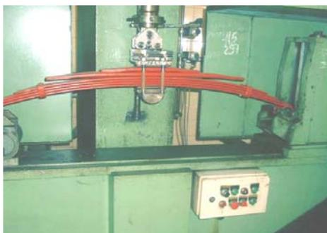
**Figura 2.** Feixe de molas montado em máquina para ensaio de fadiga
