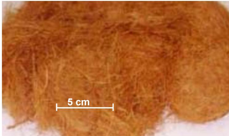
**Figura 1.** Aspecto das fibras de coco após secagem ao ar livre.
