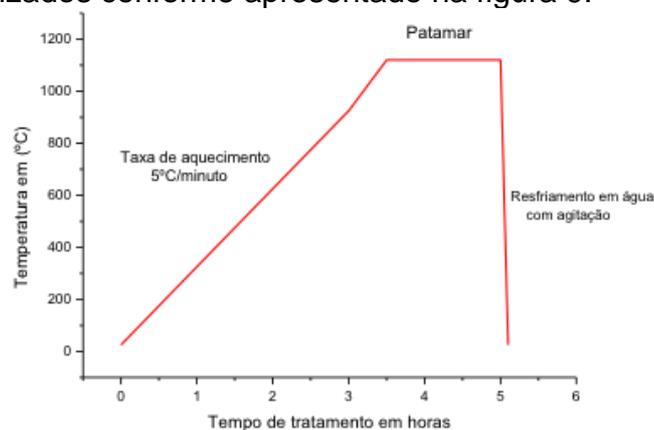
**Figura 9:** Parâmetros utilizados para o tratamento térmico de solubilização, realizado no laboratório da Faculdade de tecnologia de Sorocaba (FATEC)
