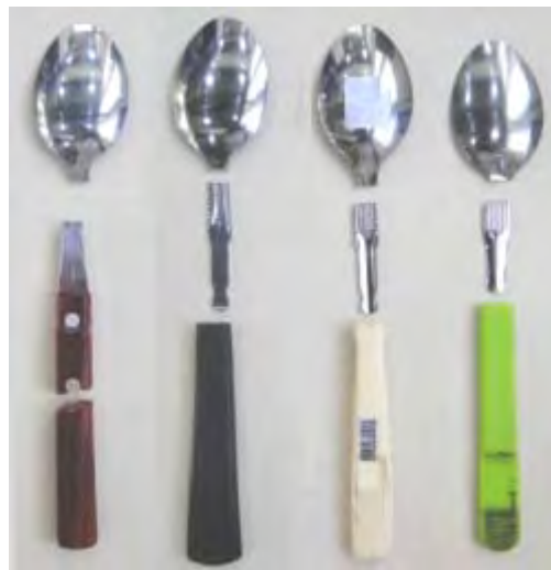
Figura 4. Colheres após ensaio de arrancamento.
