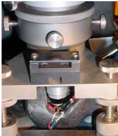
**Figura 6.** Usinagem do furo no gancho
