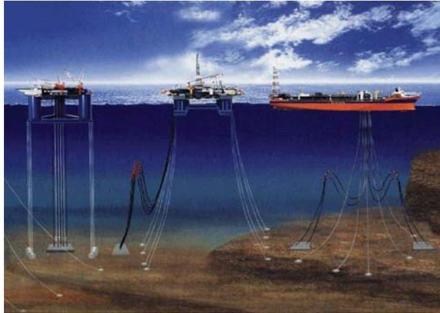
**Figura 1.** Ilustração esquemática das conexões de fundo de plataformas flutuantes.
