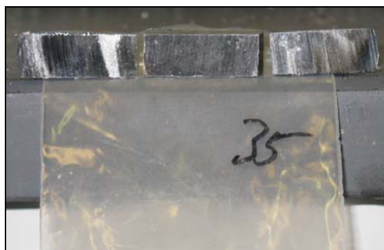
Figura 4. Amostra de aço coletada durante experimentos logo após processo de corte antes da preparação para caracterização.
