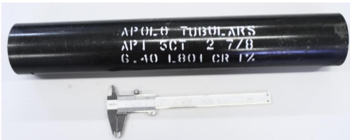
**Figura 1.** Tubo fornecido para análise ao lado de paquímetro de 150 mm.
