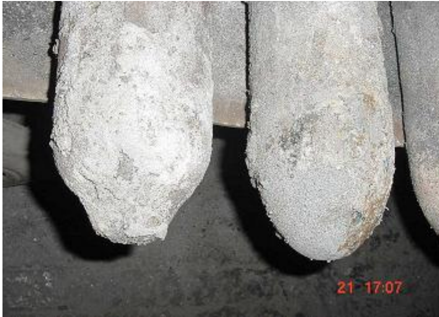
Figura 7 – Comparação visual entre tampão de usual (esquerda) e tampão com ponta de MgO (direita)
